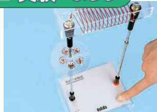
▲電流がつくる磁界の実験(右ネジの法則)
