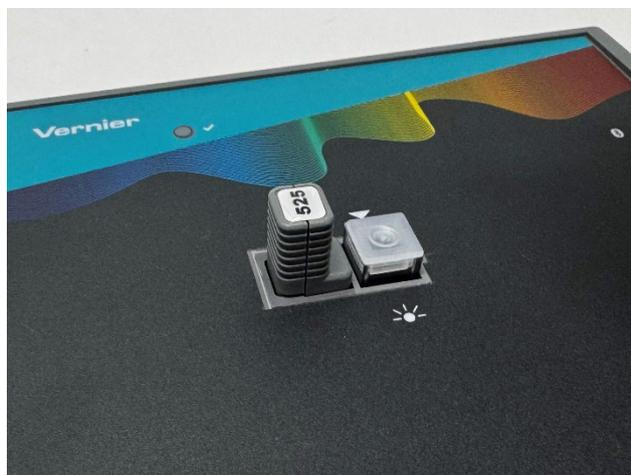
3. LED 強度を選択します。デフォルトでは 50% に設定されています。励起波長は、セットしたカートリッジの波長に自動的に設定されます。
