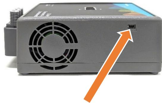
USB 接続を行う場合は PC、Bluetooth 接続を行う場合は付属の AC アダプタ (電源) に接続してください。
