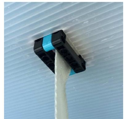
2. テザーストッパーB(フレーム)にテザーを通し、ステーション上板の下方からテザーストッパーAを挟み込み、横からアームとロングペグで固定します。
