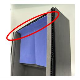
2. アクリル板を半分ほど開け、湯の入ったビーカー を本体内にセットします。ビーカーの縁ギリギリ に示温クロスが来るようにします。
