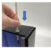
3. 実験 1 と同じように、湯の入ったビーカーをセットして温度と示温クロスを観察します。
