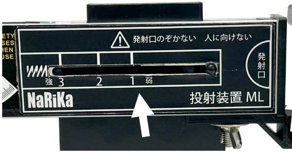
レバーを押すと固定されていた発射装置が解除され、小球が飛び出します。
