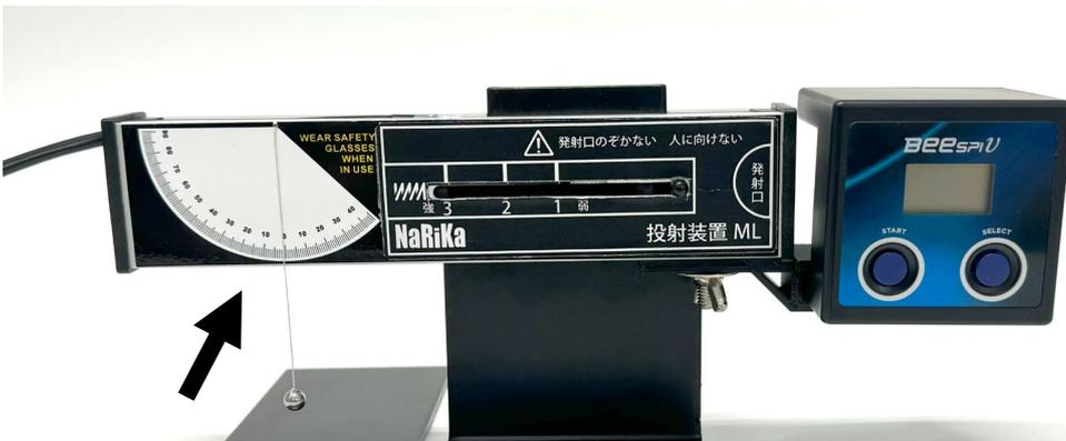
小球を投射装置本体に入れます。小球は必ず付属の鉄球をご利用ください。落下防止のため、小球は磁石で固定されます。
