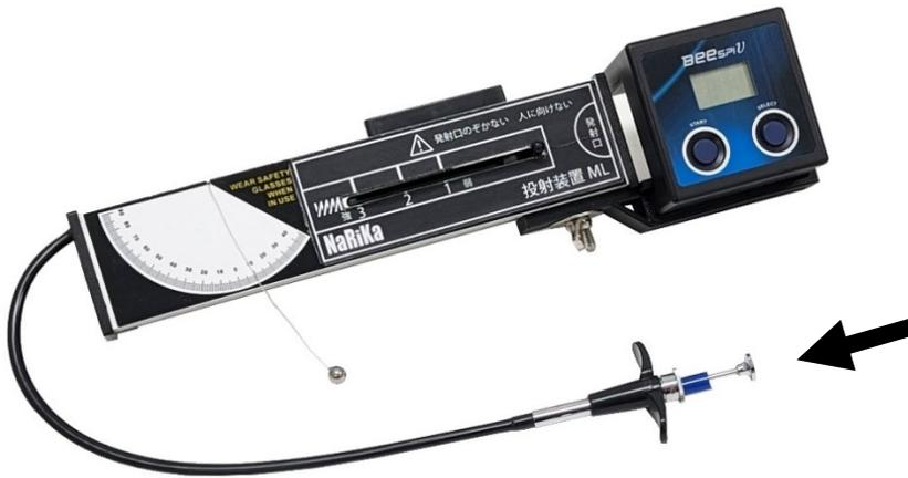
小球の初速度は、ビースピを用いて測定します。
