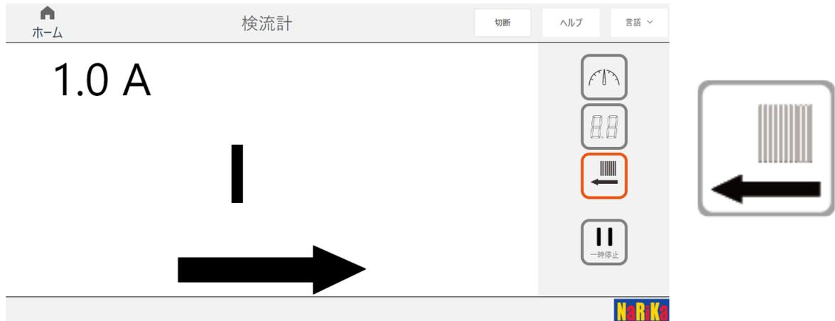
電流の値は、中央のバーが移動するスピードで表示。また左上にはその時の電流値が表示されます。電流の向きは、バーが移動する方向で表示します。
