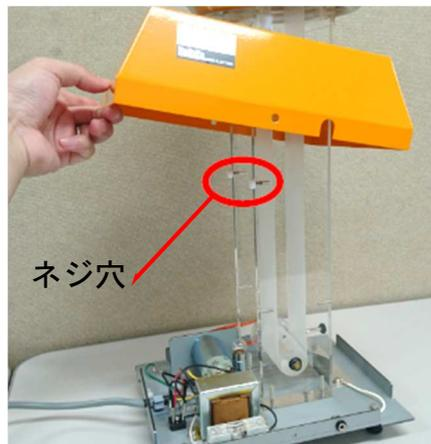
図 4. 金属カバーの仮固定 (1)
