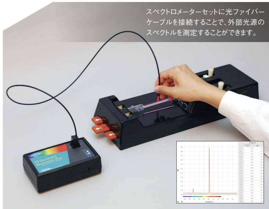
スペクトロメーターセットに光ファイバーケーブルを接続することで、外部光源のスペクトルを測定することができます。
