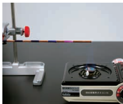
▲ 示温シールで金属の温まり方を調べる実験
