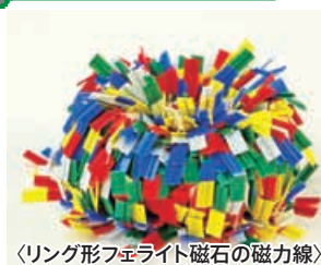
〈リング形フェライト磁石の磁力線〉
