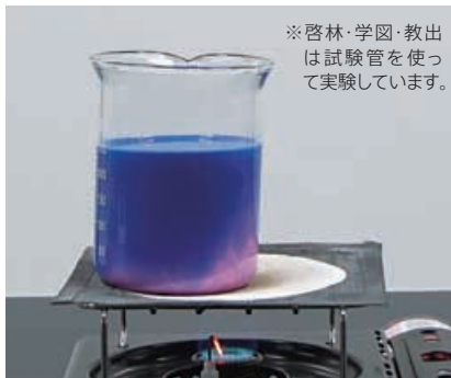
▲ 示温インク(サーモインク)で水の温まり方を調べる実験
