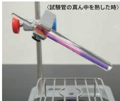
▲ 示温テープで水の温まり方を調べる実験
