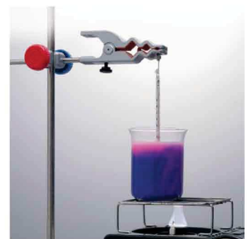
▲温度計を吊るす
