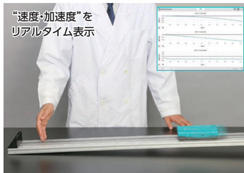
斜面の往復運動(負の加速度)を調べる実験
