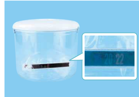
▲ 容器内の温度が下がり、袋が膨張します。袋の膨張により、減圧すると「空気が増える」のではなく、「空気塊が膨張する」ということを実感することができます。
