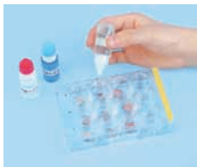
② それぞれに硫酸マグネシウム水溶液、硫酸亜鉛水溶液、硫酸銅水溶液を滴下する。
