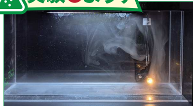
[理振品目] 熱の学習用具 ▲豆電球で温められた空気の動くようすを観察
